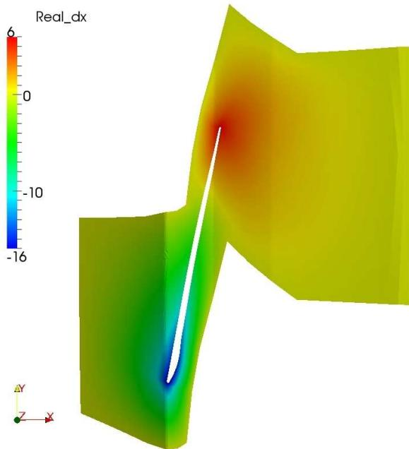
**FIGURE 16.** REAL GRID MOTION IN AXIAL DIRECTION AT 90% SPAN FOR NODAL DIAMETER 15
