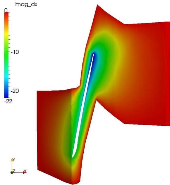
**FIGURE 17.** IMAGINARY GRID MOTION IN AXIAL DIRECTION AT 90% SPAN FOR NODAL DIAMETER 15
