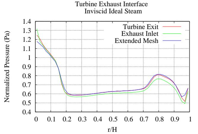
**FIGURE 3.** PRESSURE AT MIXING PLANE
