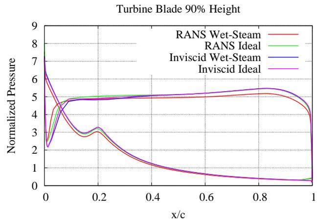
**FIGURE 21.** NORMALIZED PRESSURE ON PROFILE AT 90% BLADE HEIGHT
